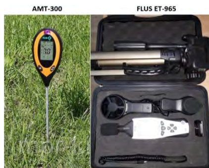
67. ábra. A levegő- és talajmikroklíma paramétereinek mérésére alkalmas műszerek
